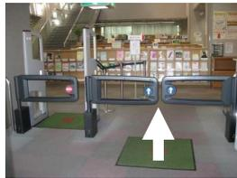
白色の矢印で示しているバーを押して中に入ります。センサーが人数をカウントします。反対が出口です。貸出手続きをせずに本を持ち出すと警報装置がなります。その時は係員の指示に従いましょう。
